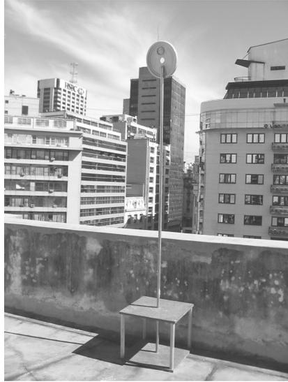
Figura 3: **Gnomón.** El gnomón construido por los alumnos consta de una base firme hecha en madera barnizada, un caño largo bien sujeto a la base y una tapa de un balde de pintura en el extremo superior del caño.
