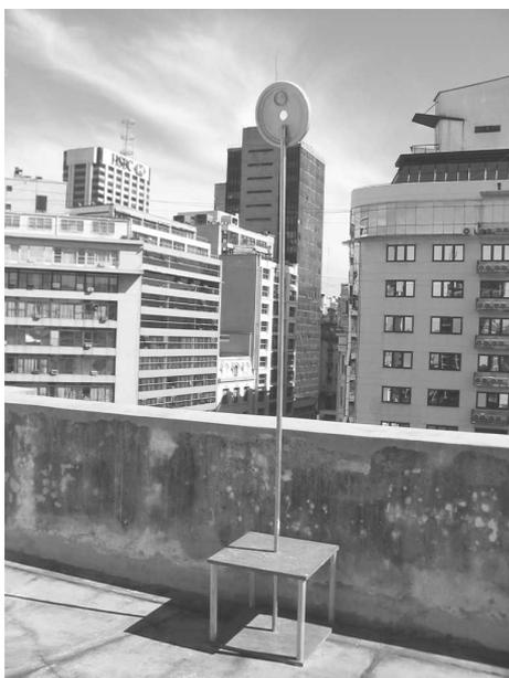
Figura 9: **Gnomón.** El gnomón construido por los alumnos consta de una base firme hecha en madera barnizada, un caño largo bien sujeto a la base y una tapa de un balde de pintura en el extremo superior del caño.
